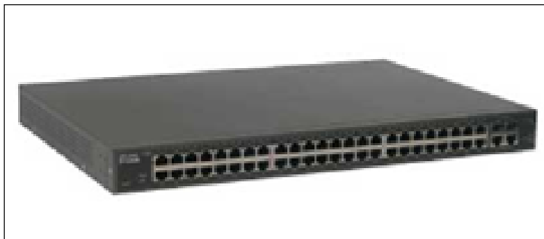
Figura 29: Switch ou Conmutador para interconexión dos elementos dunha rede Ethernet.
